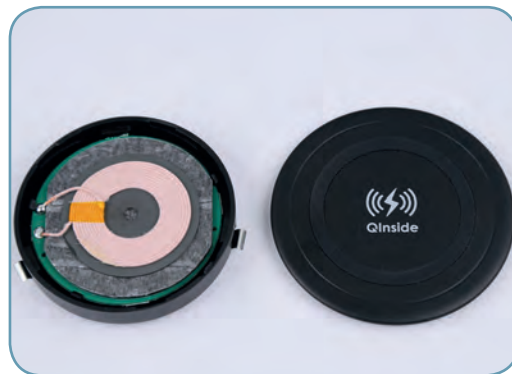
Encastré le chargeur sans le couvercle dans le meuble, en laissant 3-4 mm de matière entre le dessus du chargeur et la surface du meuble.
